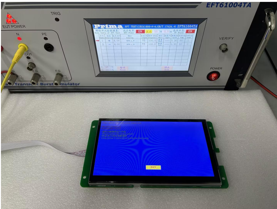
图 5-4 群脉冲测试图
