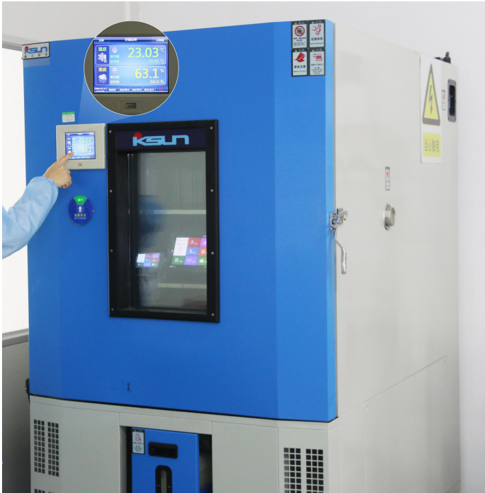
图 5-3 高低温老化测试图
